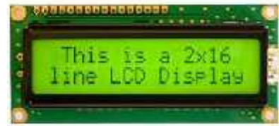
Gambar 2.8 LCD Display 2x16 LCD ( Liquid Cristal Display) berfungsi untuk [9] :
