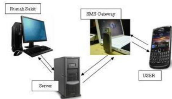
Gambar 3.1 Rancangan SMS Gateway dengan Gammu Ke Mobile Phone
