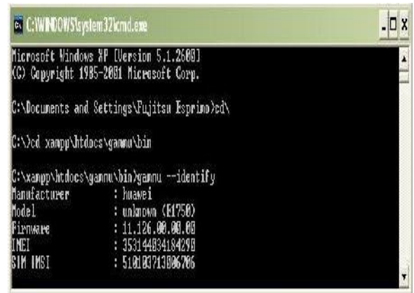
Gambar 3.5 Test koneksi Modem dengan PC/Laptop.
