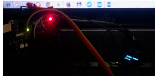
Gambar 6 Hasil Pengujian Arduino dengan menggunakan I2C IIC Serial 128X64 OLED
