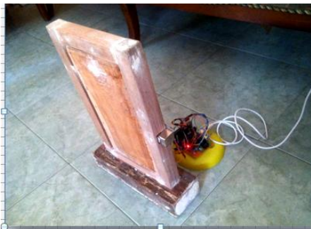
Gambar 11 Hasil Pengujian pada posisi pintu terkunci
